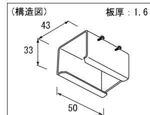
(Z-40の開き止めの補強材として使えます)
